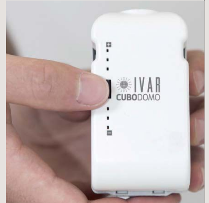
PREMERE il tasto per 20 secondi per attivare il dispositivo
